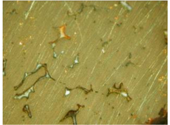
Fig. 11. Corrosione superficiale ed interna.
