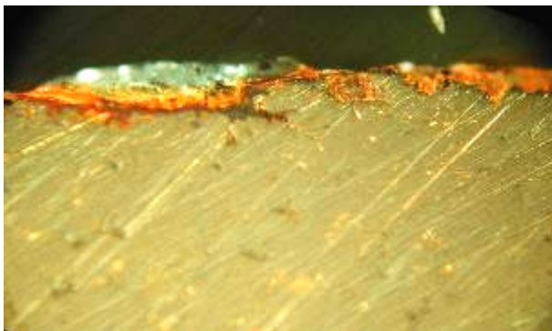
Fig. 10. Dettagli di corrosione superficiale.
