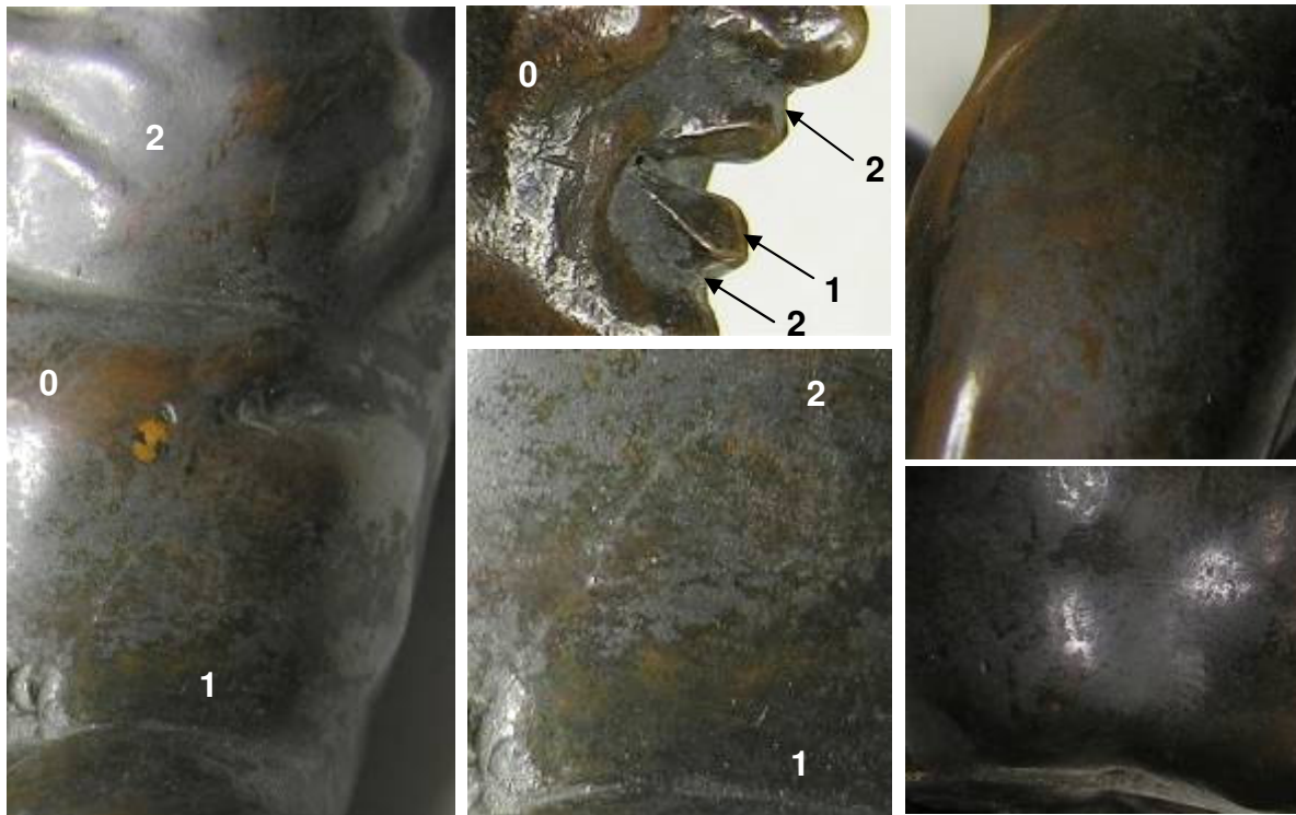
Fig. 3. Patinatura più esterna (2), patinatura originale (1) e pellicola minerale in zone consunte (0).
