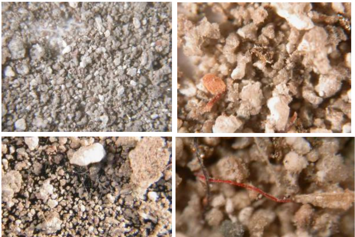
Fig. 14. Osservazione dei campioni di terra allo stereomicroscopio. Si nota: una componente biancastra predominante, minerali più scuri, frammenti di laterizio e fibre organiche.
