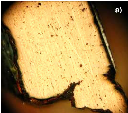
Fig. 9 Sezione lucida osservata al microscopio ottico (a) e dettaglio SEM in elettroni retrodiffusi (b). Si nota una marcata microporosità da ritiro (a) e una tipica struttura dendritica (b).
