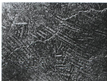
2. San Giovanni: dettaglio macro di una linea di frattura che attraversa trasversalmente le tracce di una rasiera dentata utilizzata per la finitura del modello di fusione in cera
