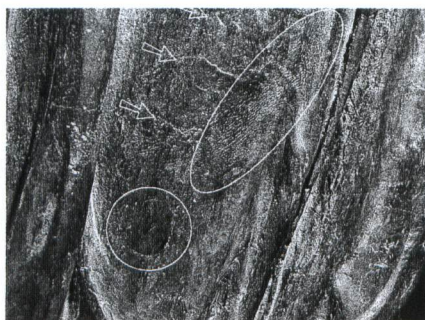
1. Salomè: dettaglio della veste nel quale è possibile riconoscere tracce di modellatura manuale della cera (freccette), cavità da ritiro (ellisse) e l'ingresso di un canale di getto
