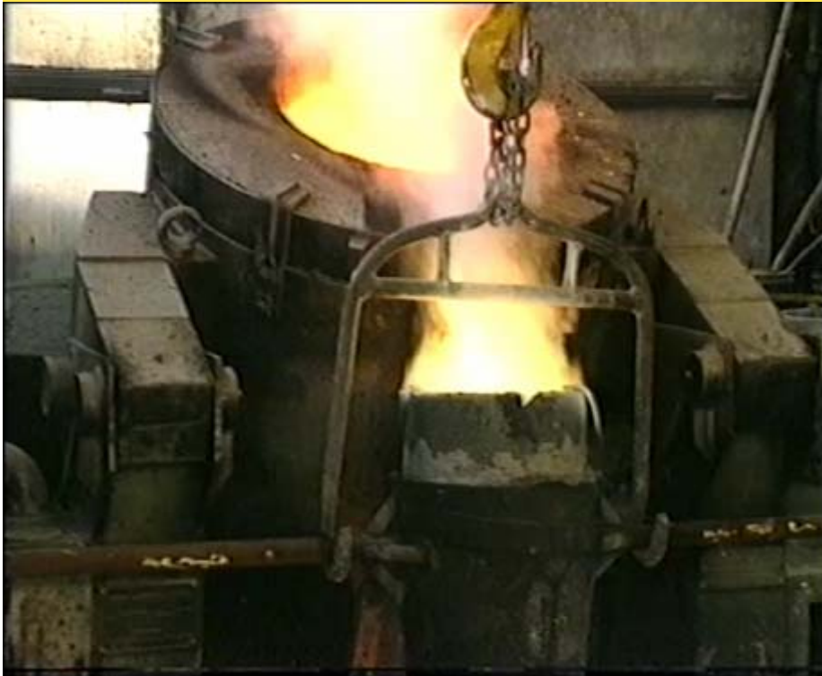
Forno per la fusione dei lingotti di bronzo
