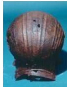
Per ottenere ciò fu necessario tagliare uno dei due perni, poiché esso risultava inglobato al coppo a causa della ruggine ed una normale pulitura e lubrificazione non sarebbero state sufficienti a rimuoverla.
