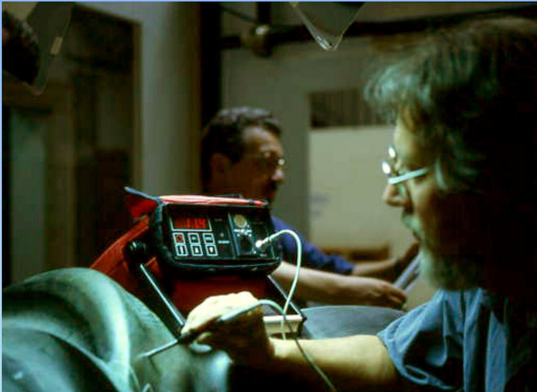
Le misurazioni di conducibilità indicano l'uso di due leghe diverse per la parte superiore e quella inferiore.
